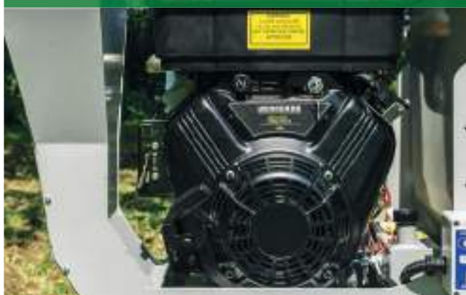
03. MOTORE UNICO PER ABBASSARE IL BARICENTRO
